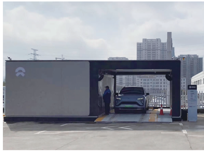
在位于安徽省合肥市的蔚来汽车换电站内,车辆自动更换电池全程仅需不足5分钟。 盛兰/摄影
