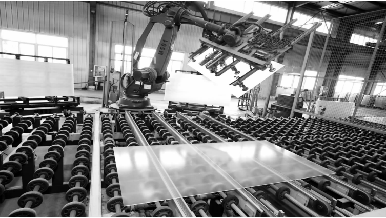
河南安阳一家光伏企业光伏玻璃生产车间，工业机器人正在生产线上对光伏玻璃产品自动堆垛。
