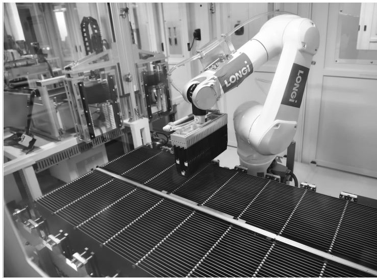
钨丝金刚线市场能否崛起原动力还在于下游硅片企业对钨丝金刚线的需求。图为隆基单晶硅太阳能电池工厂内进行镀膜工序的硅片。
