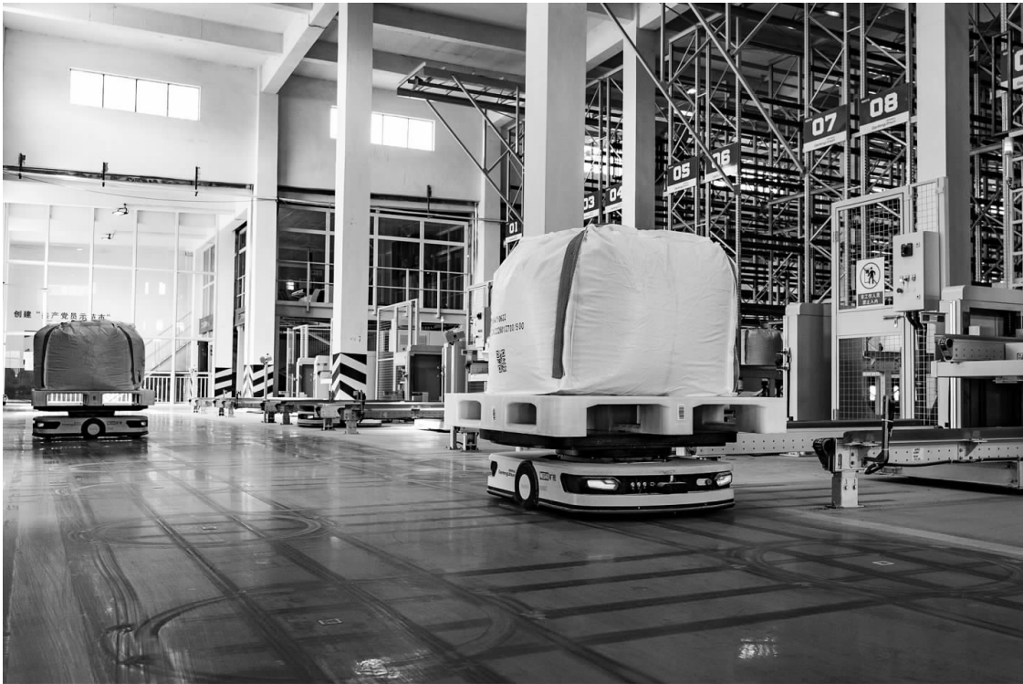
图为江西省新余市高新区锂电新能源产业园赣锋锂业的车间内,人工智能机器人正在进行备货。
