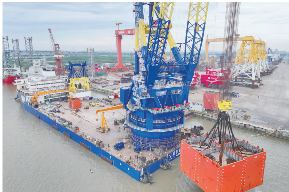
近年来，国企改革成绩突出。图为我国海上重器“华夏鲲鹏01”正在进行3500吨吊重试验。
