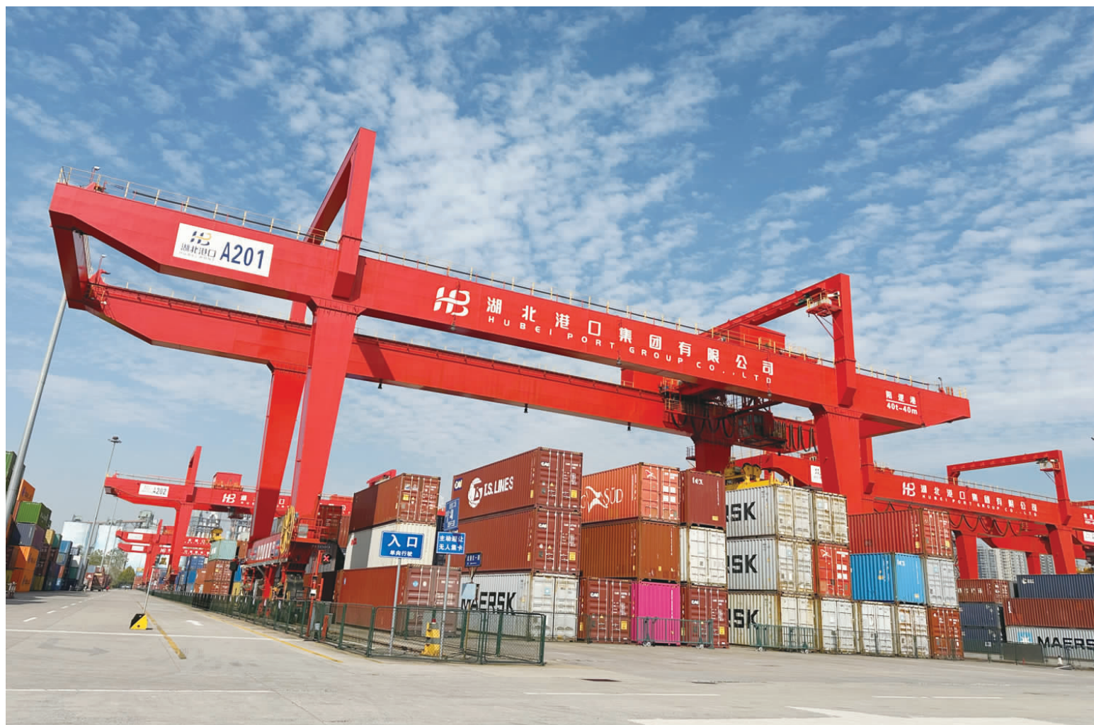
在武汉阳逻港A区，集装箱整齐码垛，远程自动控制的“龙门吊”正在作业。
