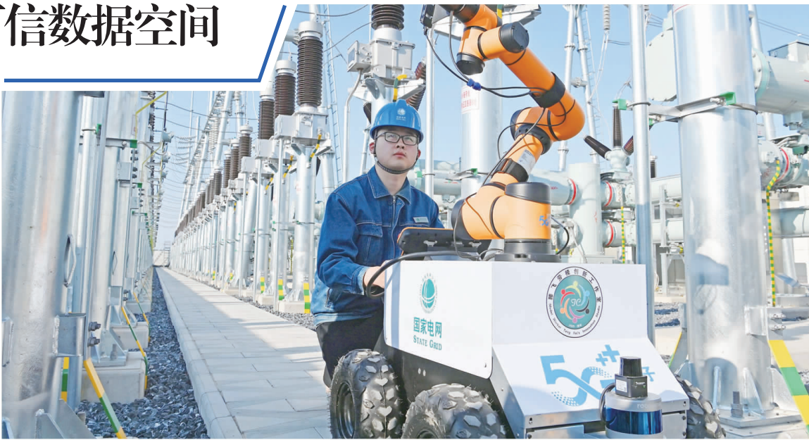
4月2日,在安徽省滁州市南谯区220千伏红桥变电站,技术人员正在对一台搭载DeepSeek大模型技术的智能巡检机器人进行巡检数据校核。视觉中国/图
