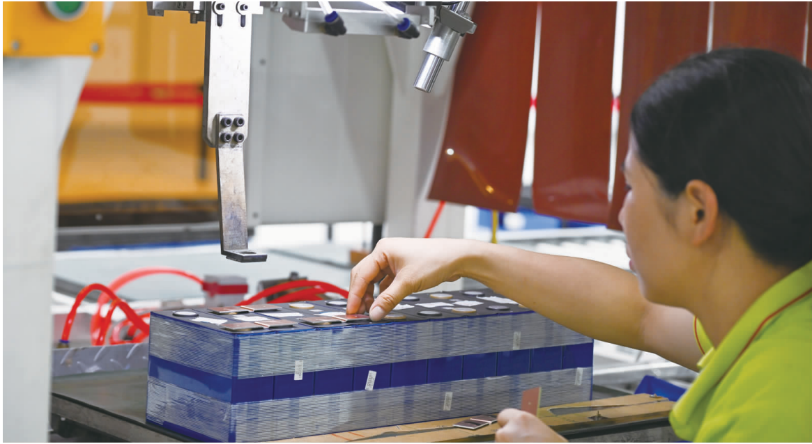
图为重庆弘禧汽车科技公司工人在加工电池。动力电池退役时还有剩余储能能力,规范处理后可梯次利用。
