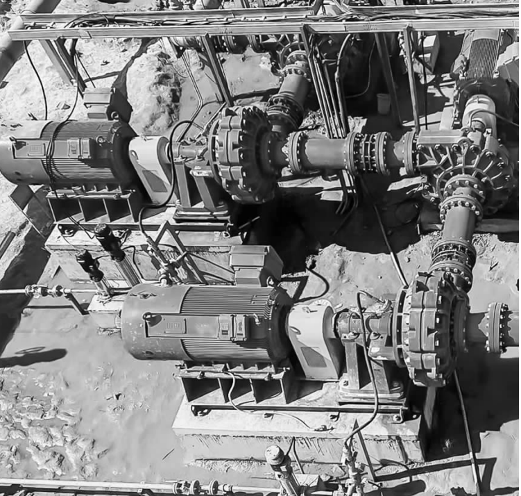
图为耐普矿机五级串联装置。
