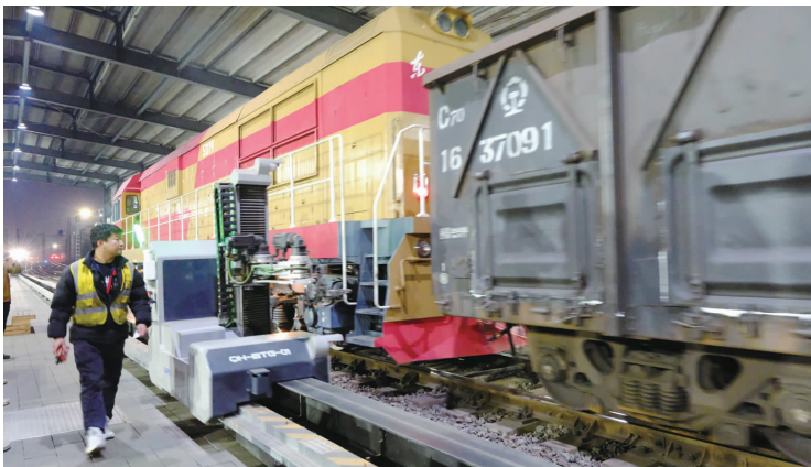
11月25日，裕国站驼峰连接员和摘钩机器人正在进行人机协作摘钩测试作业。
