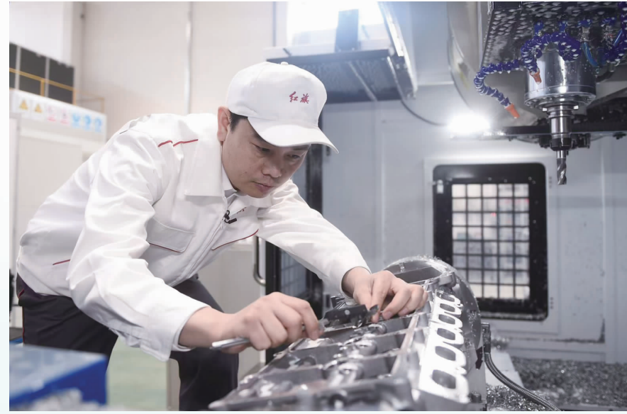
杨永修正在测量缸盖的局部尺寸。
