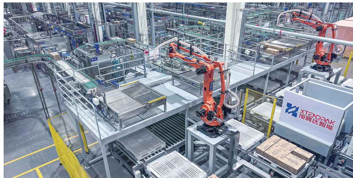
2026年4月25日，乌鲁木齐，新疆天润乳业智能工厂内，视觉机器人精准码垛，无人车穿梭自如。
