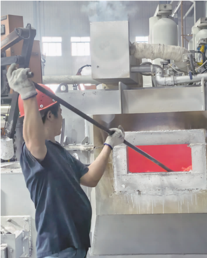
贵州蓝辉新材料有限公司工人正在从熔炉里捞出废渣。
