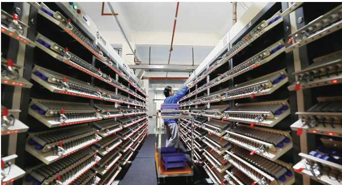
图为湖南锂都工作人员对锂电池电芯开展化成充电作业,以激活电芯性能。 本报资料室/图
